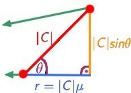
$\mu$ : Man betrachtet den Winkel zwischen der Charakteristik und der geradlinigen Verbindung zwischen Anfangspunkt und Endpunkt ( $\theta$ ). Den Cosinus von  $\theta$  nennt man  $\mu$ . Dieser läuft auf der selben Strecke wie  $r$  wird aber in Charakteristikenlängen skaliert (in der Grafik blau dargestellt).
