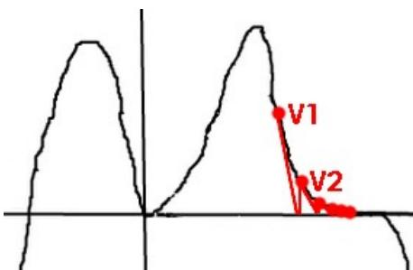
In dieser Grafik probiert der Forscher sich mit dem Newtonverfahren der selben Lösung zu nähern. Man erkennt, dass er weniger Versuche als zuvor benötigt um dieselbe Genauigkeit zu erhalten.
