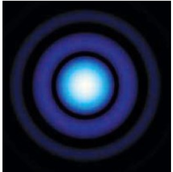
Abb. 1: Diese Ringe entstehen, weil sich Licht wie eine Welle überlagert.
